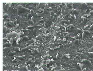
MSコート Hysブロックジェルにより封鎖を確認
